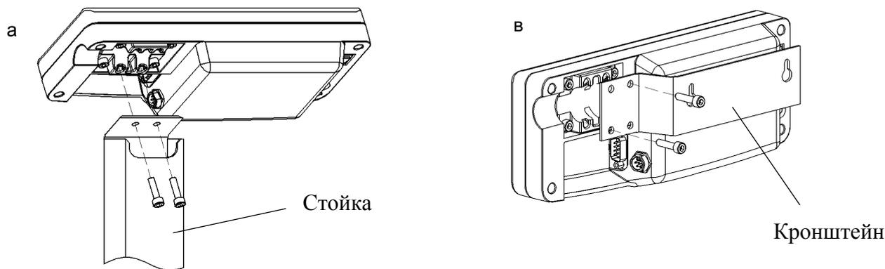
Рис. 5.3 - Варианты крепления устройства индикации
