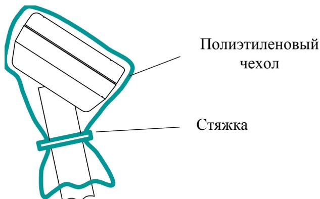
Рис. 6.2 - Защита устройства управления
