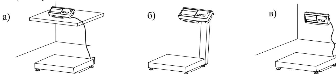
Рис. 6.1 - Варианты размещения устройства управления
