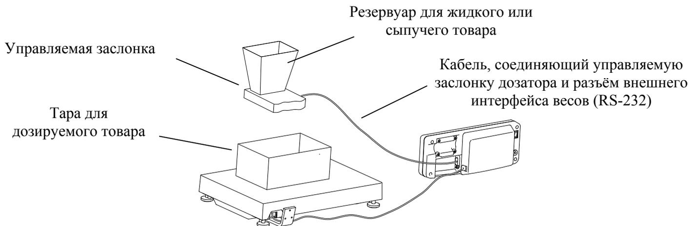
Рис. 7.2 - Подключение весов к дозирующему устройству
